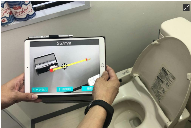
見積アプリ『FUSII』による手すりの設置
